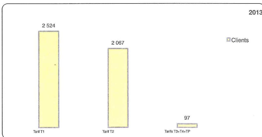
T1 (< 6 MWh/an) : usage cuisine. T2 (6 à 300 MWh/an) : chauffage domestique, écoles, Pmi. T3 (300 à 5 000 MWh/an) : Pme, piscines, groupes scolaires. T4 (> à 5 000 MWh/an) : grands ensembles immobiliers. TP : très gros consommateurs raccordés au réseau de distribution.
